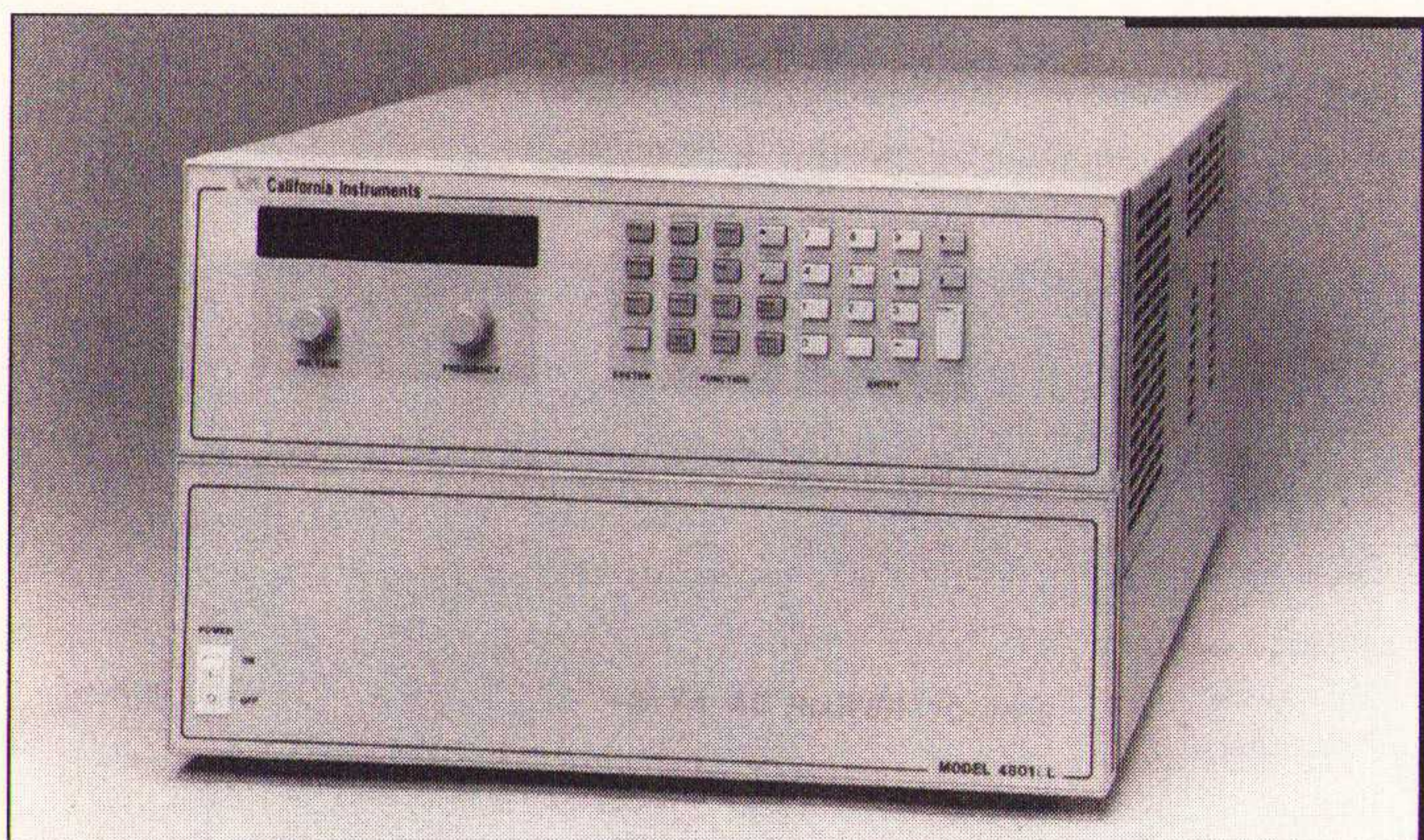
Afb. 4 - De California Instruments 4801iL is speciaal bedoeld voor het uitvoeren van testen volgens IEC1000-3-2 en IEC100-3-3. Hierbij wordt het te testen product gevoed met een zuivere bekende netspanning en wordt geanalyseerd welke harmonische vervorming ontstaat en in welke mate het product het lichtnet wisselend belast. In de 4801iL zijn zowel de voeding als de poweranalyser geïntegreerd. De bijbehorende software verzorgt alle metingen, tot het uitdraaien van het meetrapport toe.
