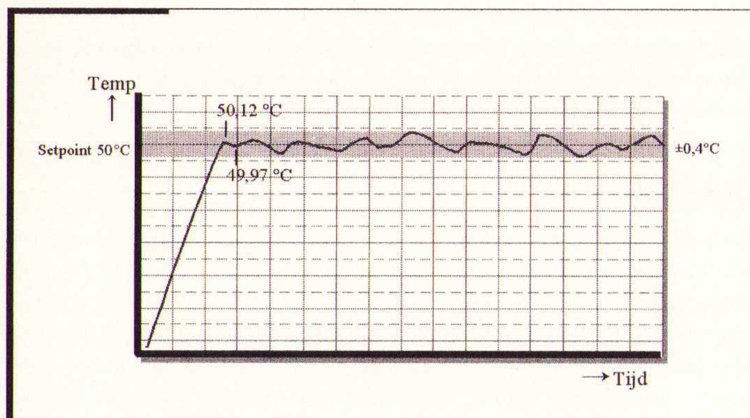
Fig. 9 - Resultaat regelaar na stap van kamertemperatuur naar 50 °C
