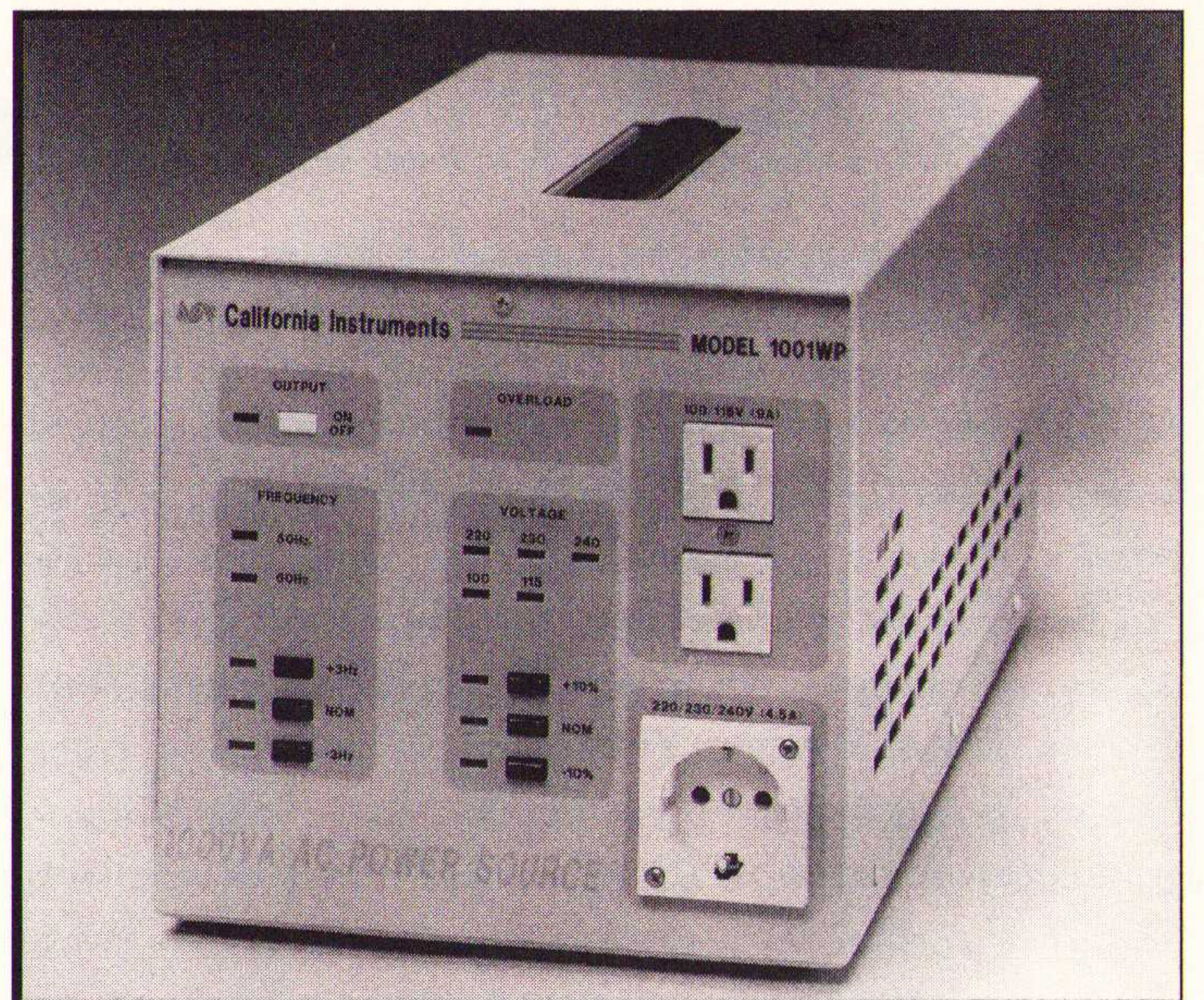
Afb. 3 - California instruments 1001iWP. Deze switching AC-voeding kan ondanks haar kleine afmetingen toch continu 100 VA leveren. Zij is bedoeld voor die plaatsen waar een schone, stabiele netspanning is vereist, met een frequentie van 50 of 60 Hz naar keuze. Ideaal voor het voeden van meetapparatuur in productie-omgevingen.
